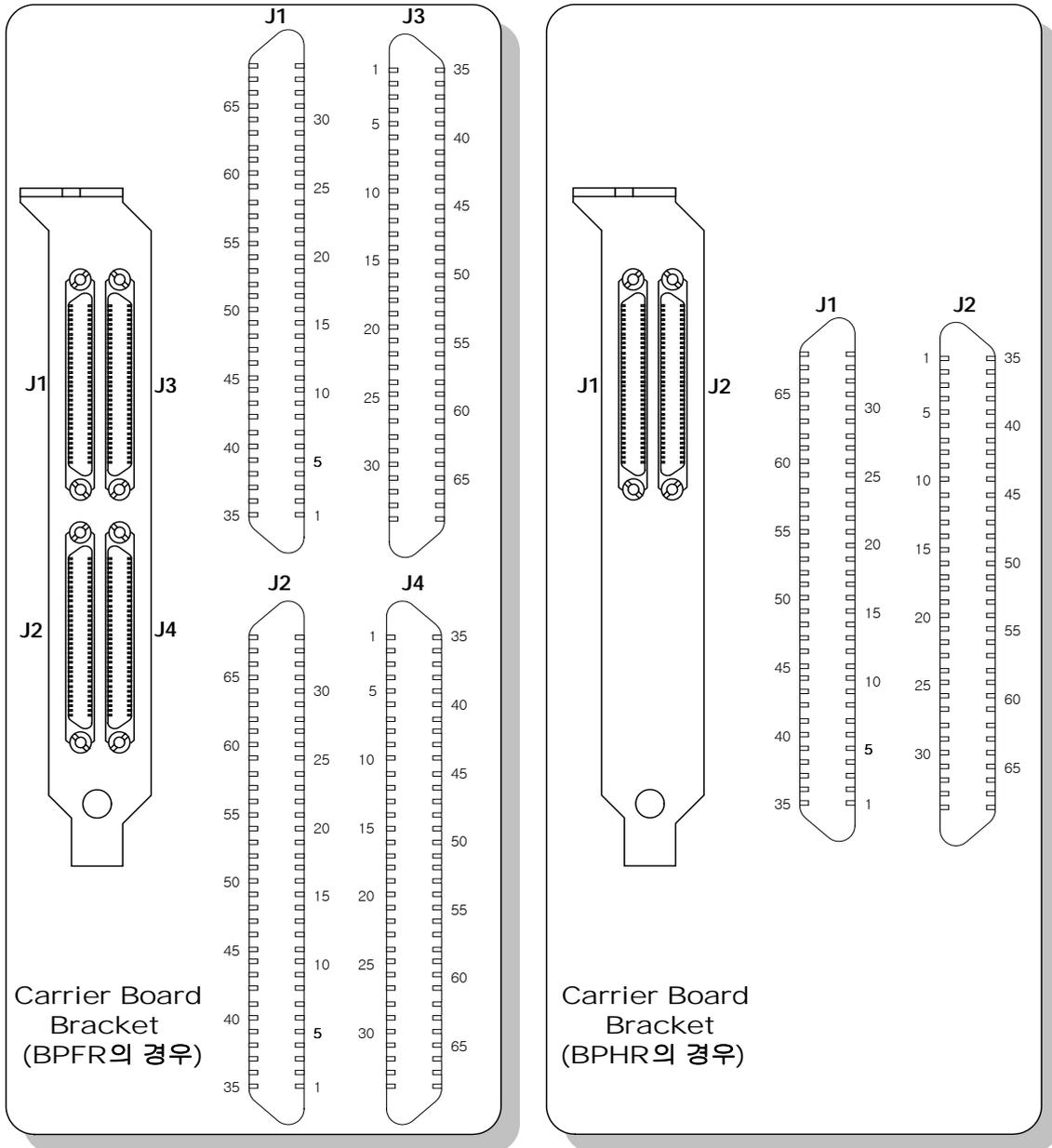
그림 9. Carrier Board 외부 커넥터 배치도
