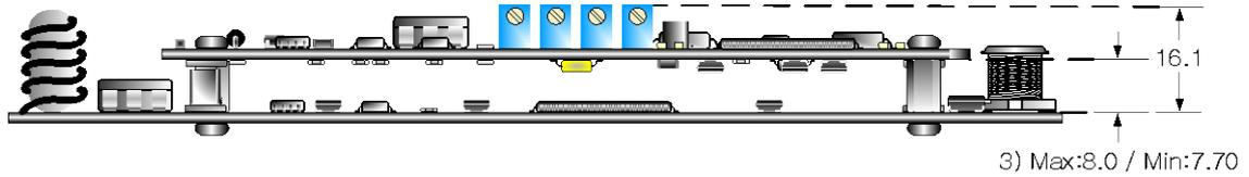
그림 5. Carrier Board에 SIO-A04RB를 장착한 모습
