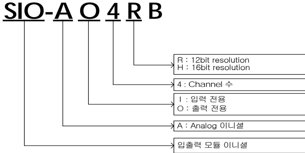
그림 17. AnyAIO 모델명 표시 방법
