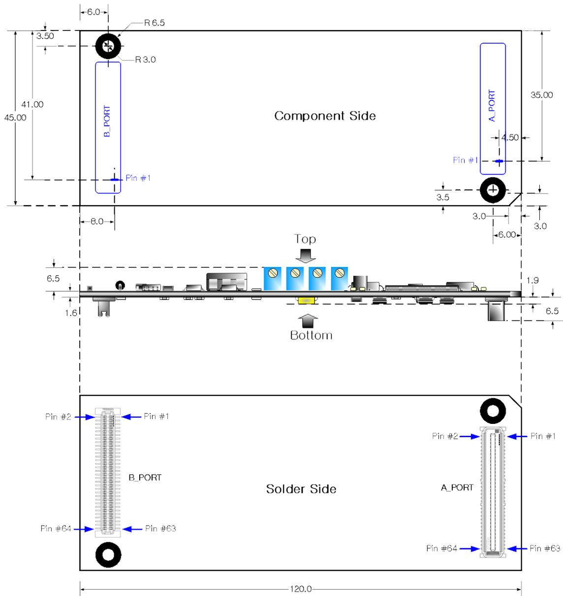
그림 3. SIO-AO4RB Dimension(단위:mm)
