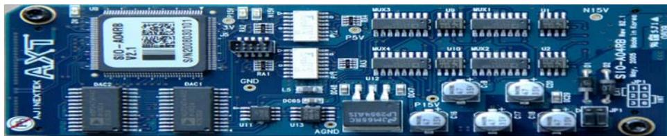
그림 1. SIO-A04RB 실물 사진 (전면)
