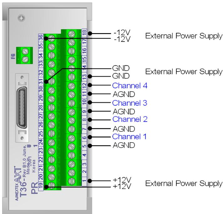
그림 12. SI0-A04PB사용 시 T36-PR v1.0 & T36-PR v2.0 결선도
