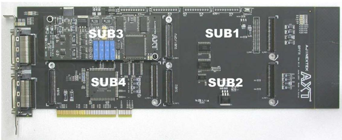
그림 16. BPFR에 장착된 SIO-A04RB
