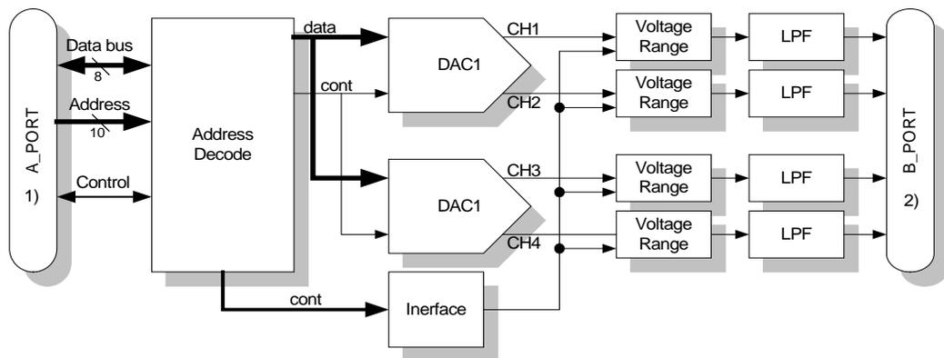
그림 2. SIO-A04RB 블록도
