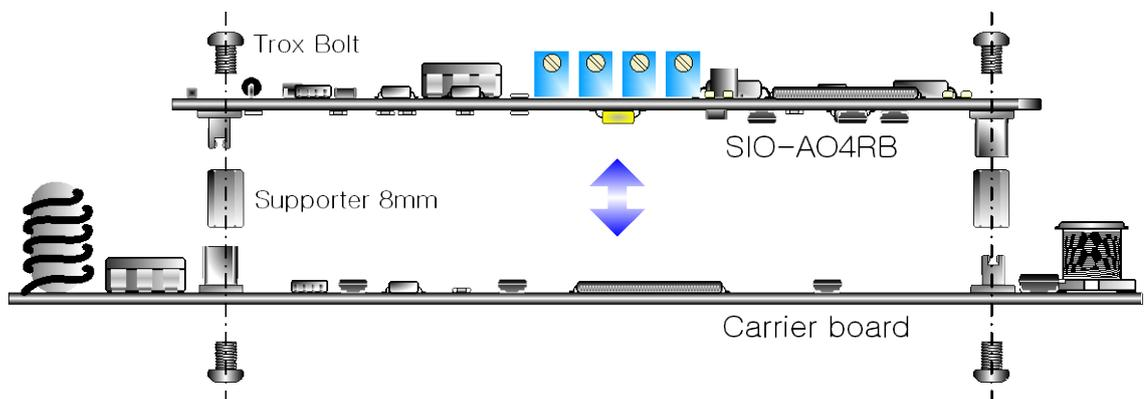
그림 4. Carrier Board에 SIO-A04RB를 고정하는 법(그림 6 참조)
