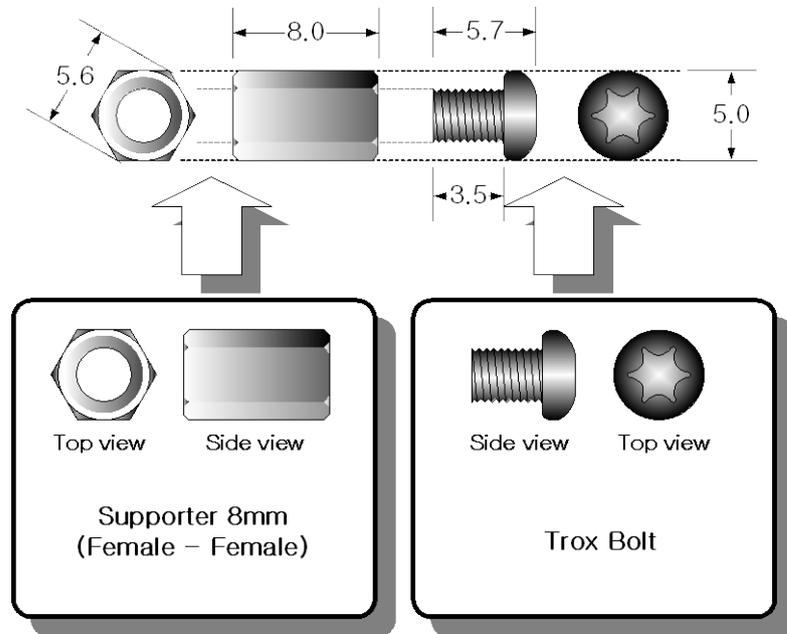
그림 6. Supporter / Bolt 종류와 크기(단위:mm)
