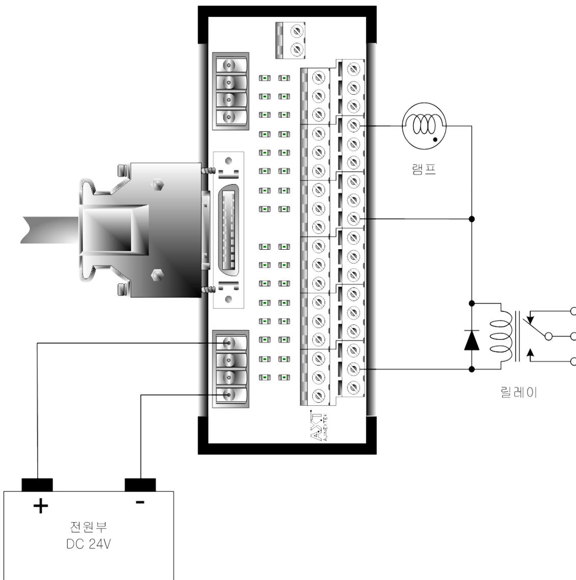
그림 18. APC-EO36 단자대를 이용한 기본 구성
