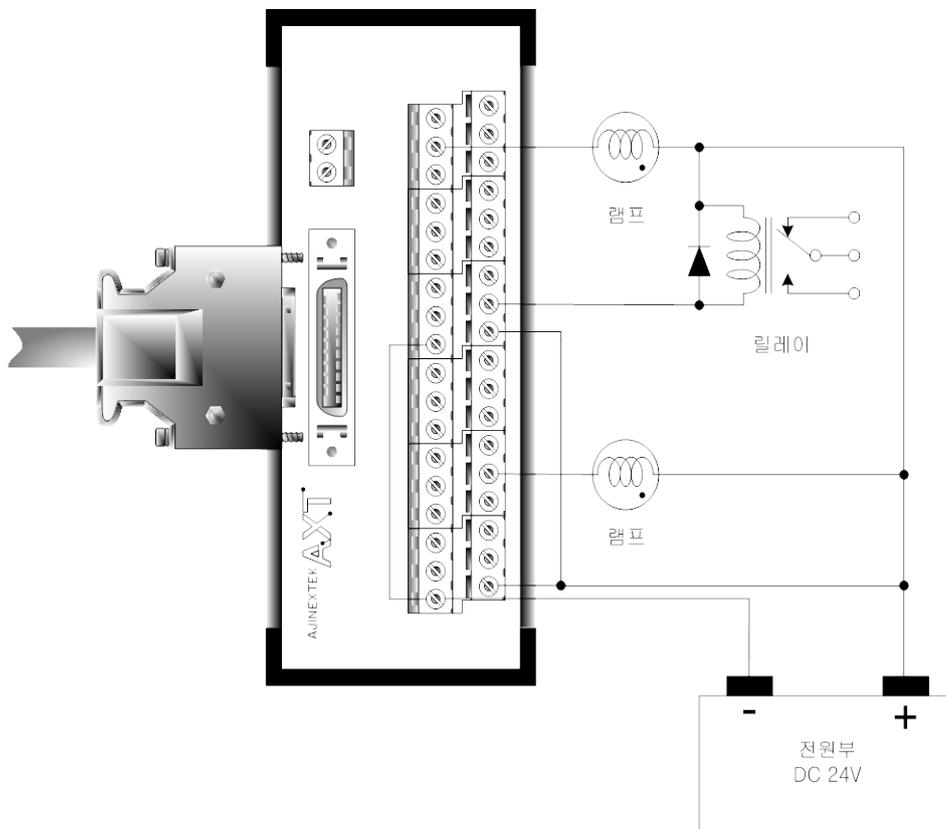
그림 17. T36-PR 단자대를 이용한 기본 구성
