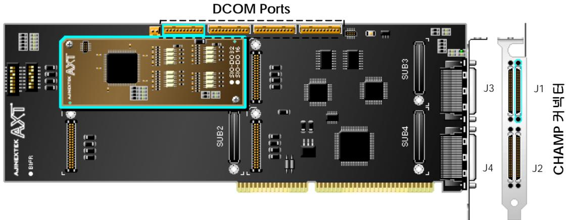
그림 9. BIFR보드 SUB1에 SIO-DO32P가 장착 된 경우
