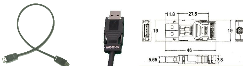
그림 7. ML-II용 Cable 및 Connector 사양
