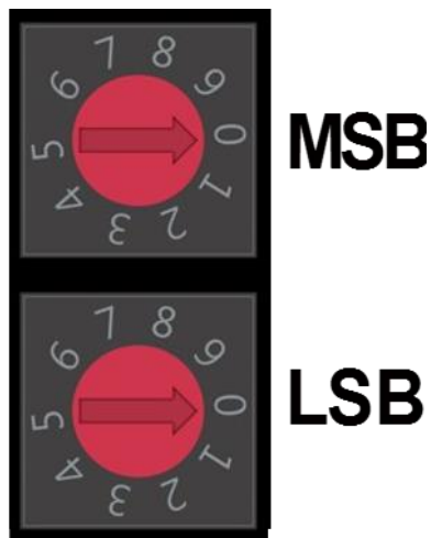
그림 8. N3SIIIH-CNT2 모듈 NODE ID 스위치
